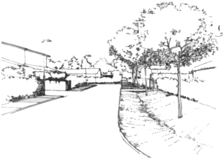
Photo 12- Une large noue latérale, enherbée et plantée d'arbres en alignement, filtre les eaux de ruissellement.
