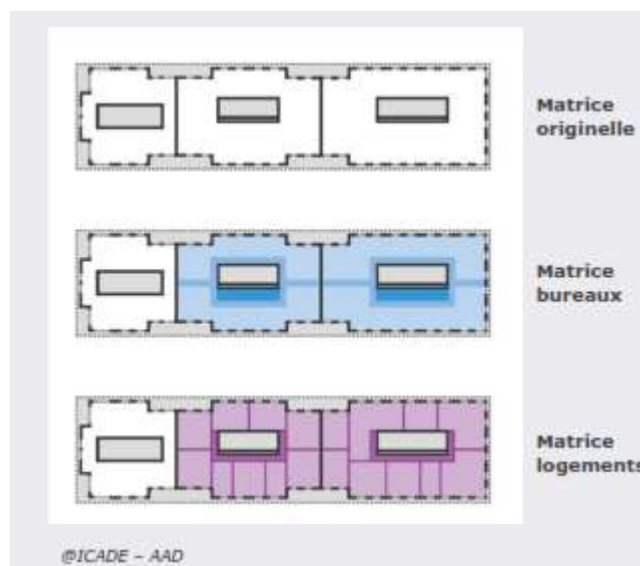
Figure 15 : Différentes matrices d'un bâtiment réversible
