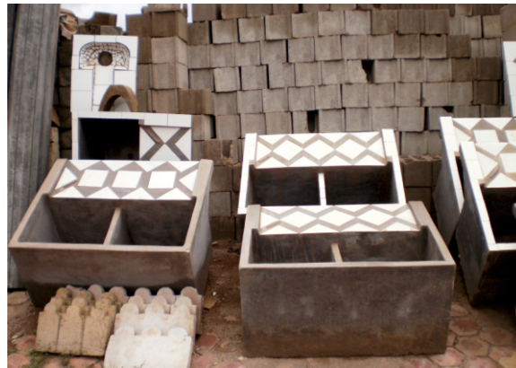
Photo 4: Eviers et pot de toilette en béton de ciment
