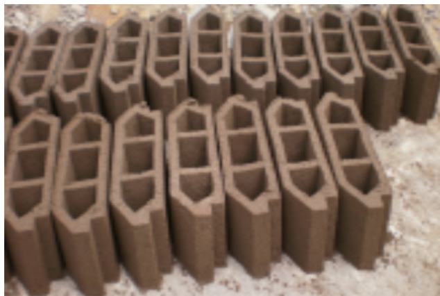
Photo 6: hourdis en mortier de ciment et moule pour hourdis
