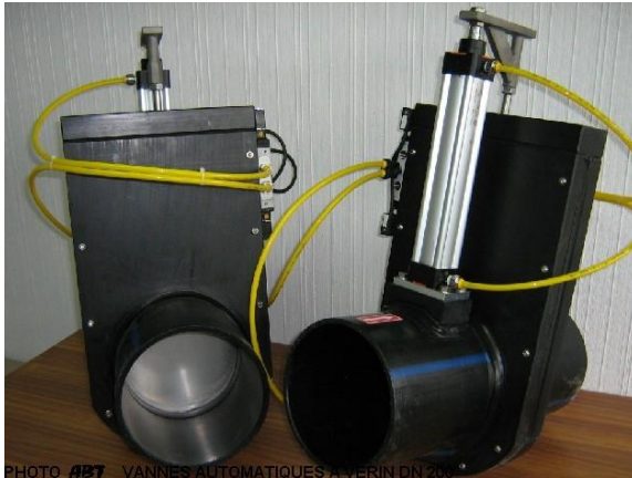
Vanne automatique DN200
