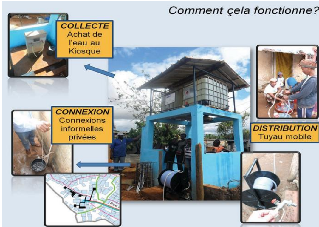
Image 8: Principe de fonctionnement d'un kiosque à eau
