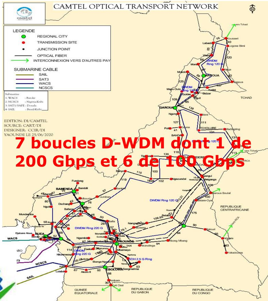
Le réseau de transport national de CAMTEL a pour support principal la Fibre Optique et s'étend sur plus de 12,000 kms.
